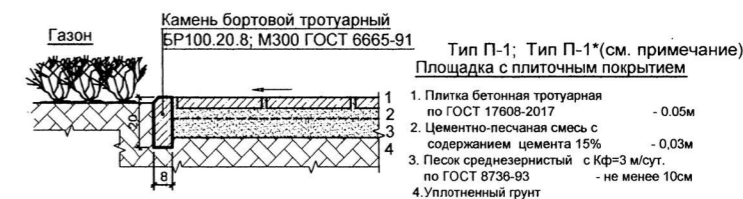
Сопряжение покрытий аллеи с газоном
