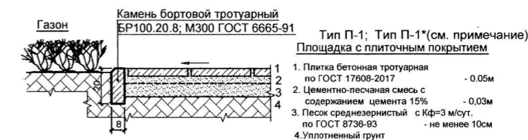
Сопряжение покрытий аллеи с газоном
