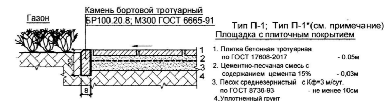
Сопряжение покрытий аллеи с газоном
